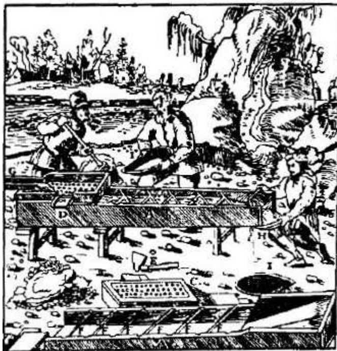
Рис. XIII-35. Промывка золотоносного песка (XVI век).
